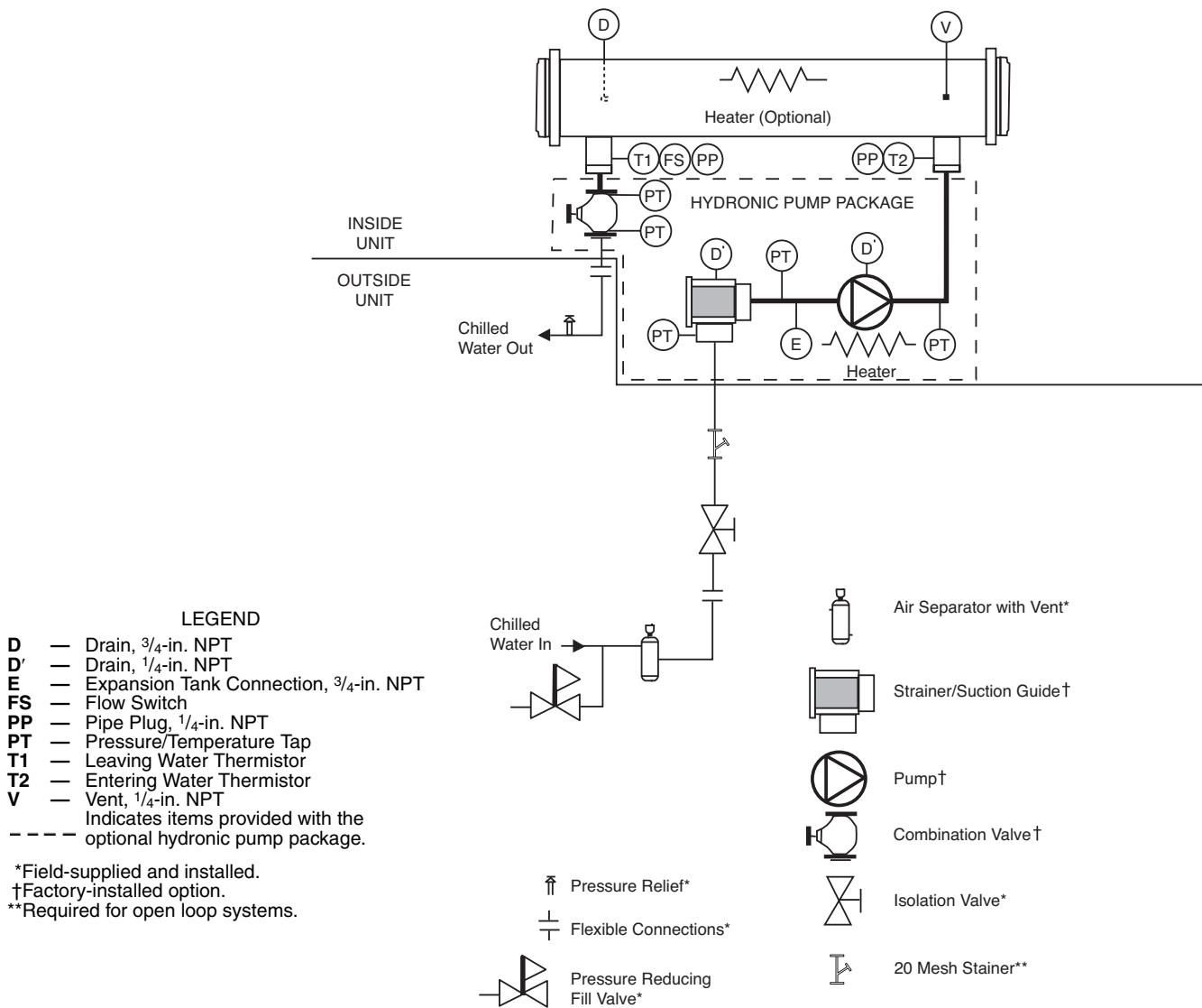
**TYPICAL PIPING DIAGRAM FOR 30RB UNITS WITH HYDRONIC PACKAGE — DUAL PUMPS**
