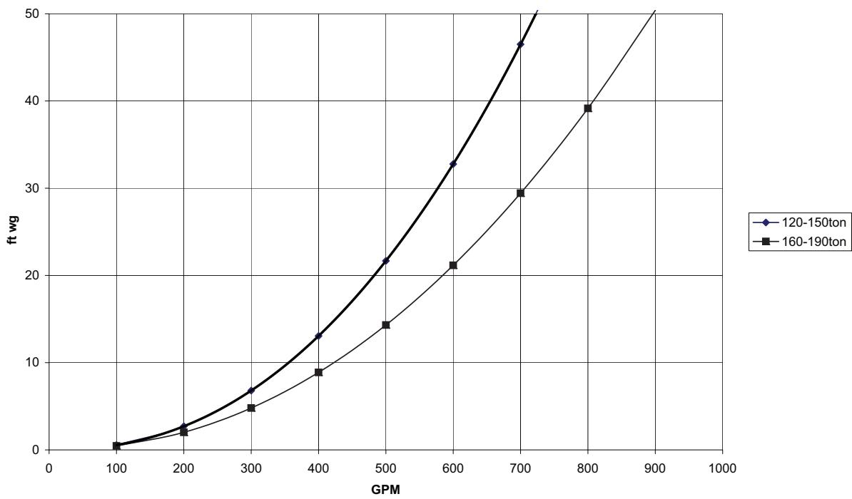
**PUMP CURVE I FOR HYDRONIC PACKAGE SINGLE PUMP (Fresh Water)**
