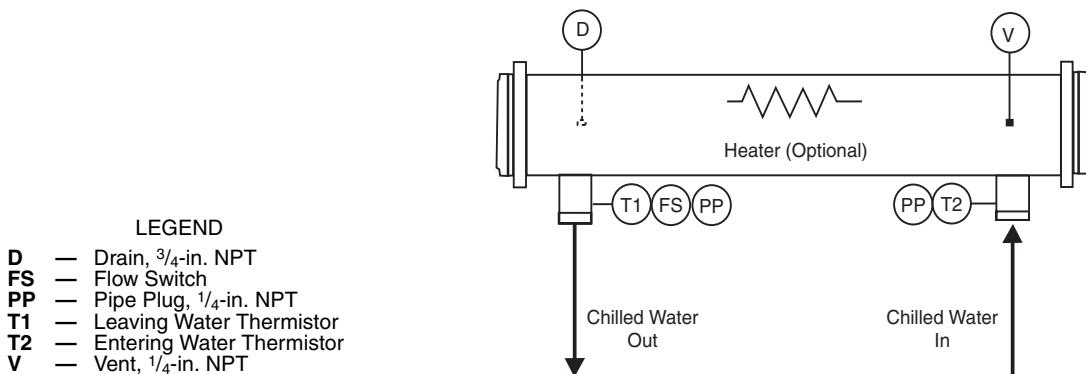
TYPICAL PIPING DIAGRAM FOR 30RB UNITS WITH HYDRONIC PACKAGE — SINGLE PUMP
